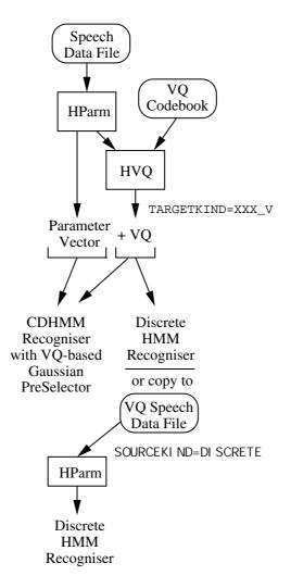
Fig. 5.8 Using Vector Quantisation
